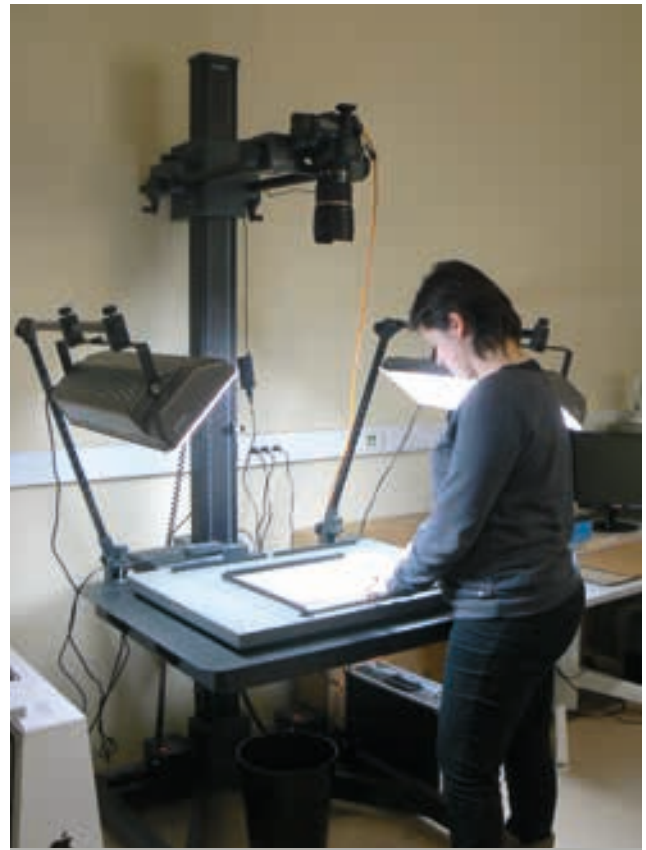
— Een herbariumtechnicus aan het werk met een van de vier PENTAX 645Z opstellingen voor het digitaliseren van herbariumspecimens. Foto Sofie De Smedt.
